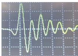
Рисунок 4. Осциллограмма ультразвукового импульса: амплитуда 100 мВ, масштаб времени 1 мкс/клетка.
