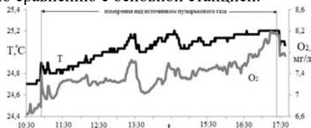
Рисунок 3. График изменения температуры T (черный график) и концентрации растворенного кислорода O_2 (серый график) в течение 6-часового непрерывного in situ мониторинга. Выделенная область показывает временной интервал, когда измерения проводились непосредственно над источником пузырькового газа.
