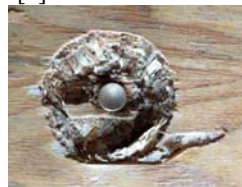
Рисунок 3. Результат выстрела ледовой пушки: в центре мембрана, вокруг след взаимодействия переохлажденной воды с деревянной мишенью.
