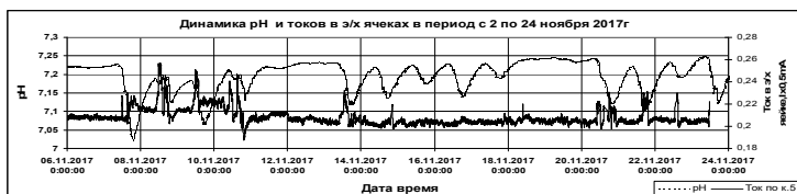
Рисунок 1. Динамика водородного параметра pH и токов в электрохимических ячейках в период со 2 по 24 ноября 2017 г.
