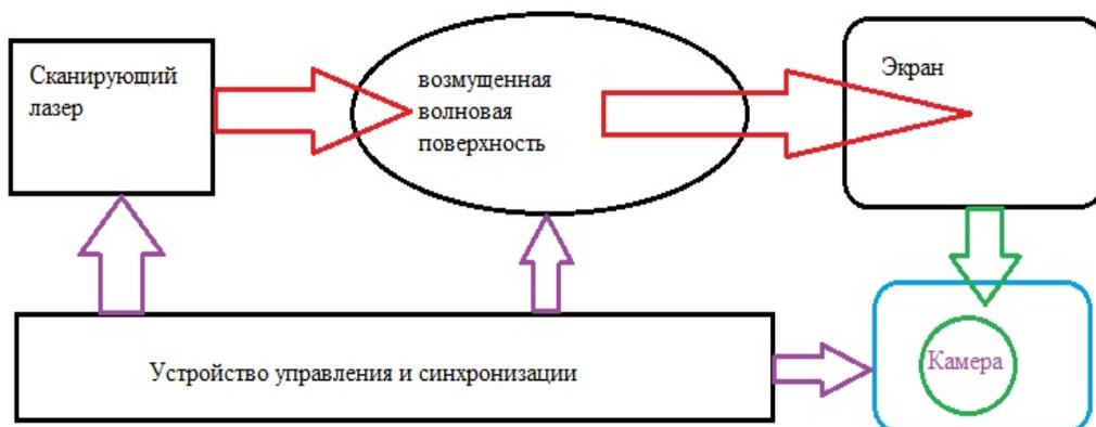
*Рисунок 1. Блок-схема лазерного сканирующего волнографа*
