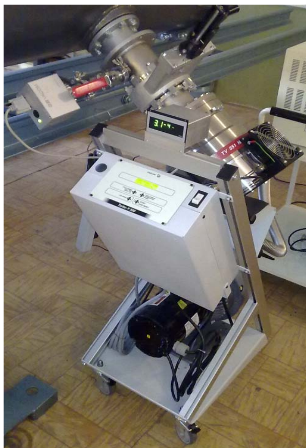
Рис. 63. Подсоединенный к секции ресивера вакуумметр VACOM ATMION с дисплеем VACOM ATMIGRAF, располагающийся на откачном poste TV 551.
