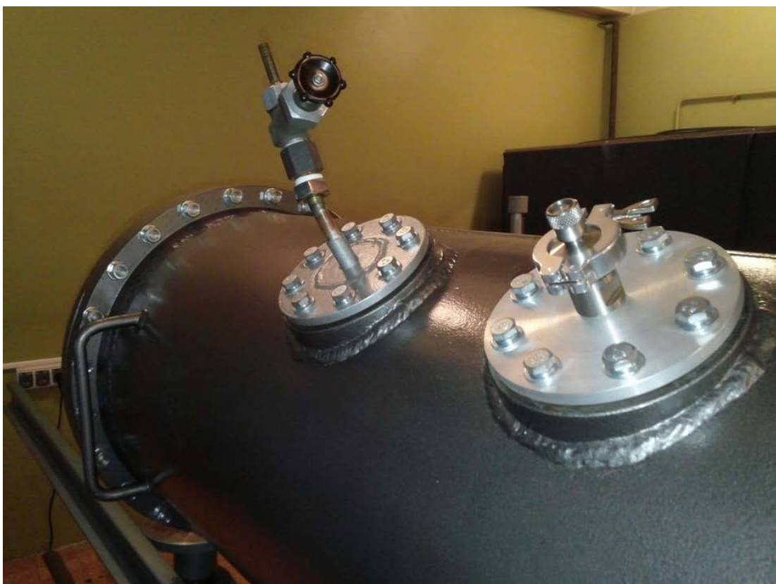
Рис. 64. Стравливающий кран и клапан аварийного сброса W25K секции ресивера.
