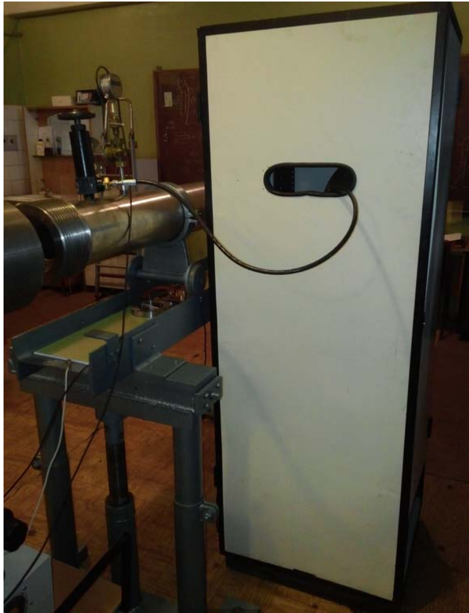
Рис. 110. Шкаф баллонов с гибким подводом для заполнения КВД.
