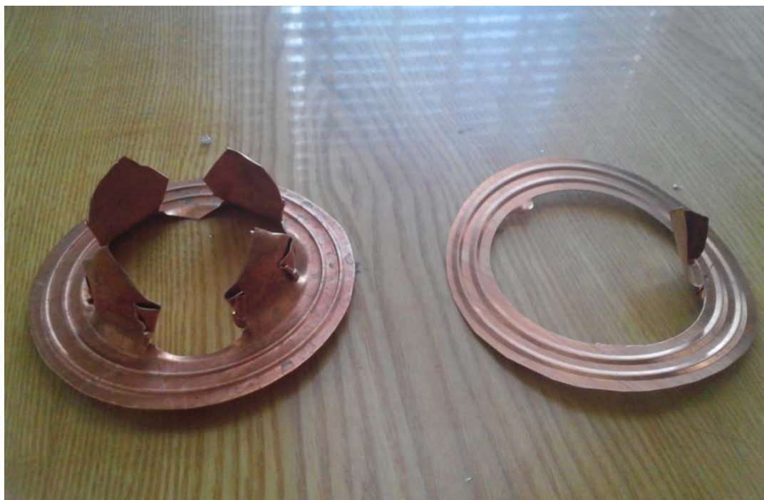
Рис. 57. Раскрывшаяся медная мембрана с 4 лепестками (слева) и мембрана с оторванными лепестками (справа).
