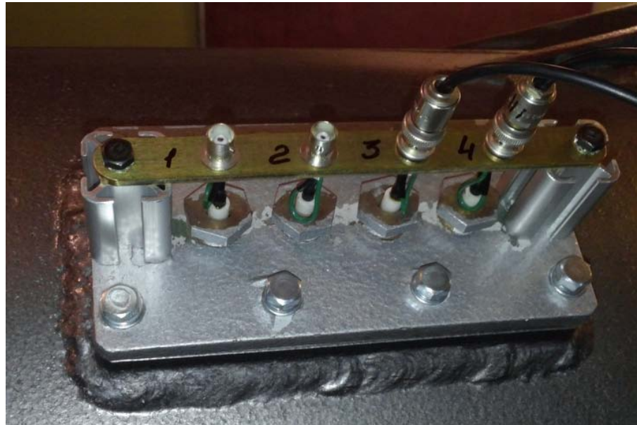
Рис. 120. Крепления разъемов BNC с внешней стенки секции ресивера.
