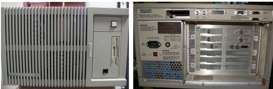
Рис. 7. Система регистрации данных Tektronix test lab 2520 [48, 49].
