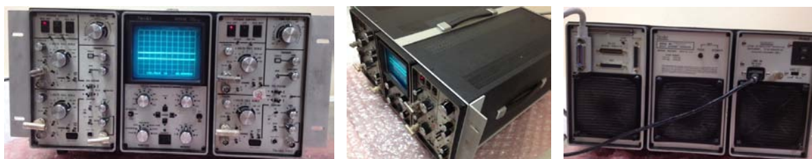
Рис. 8. Система визуализации аналоговых данных измерительных устройств с помощью осциллографа Nicolet 4094C [50].
