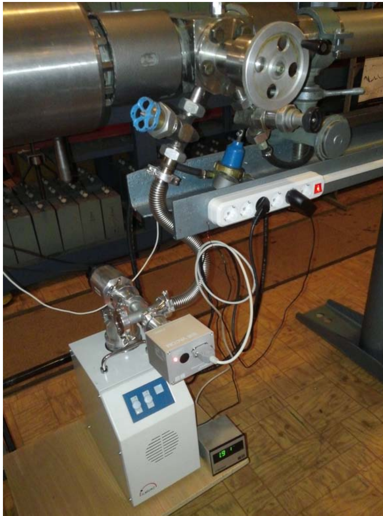
Рис. 60. Турбомолекулярный вакуумный стенд Итvac CDK-180, подсоединенный к секции КНД
