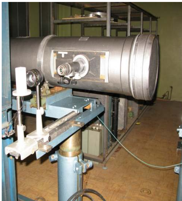
Рис.55. Блок осветителя оптической системы ГУАТ.
