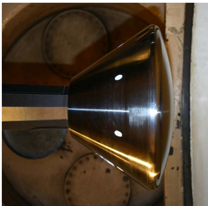
Рис. 17. Исследуемый макет [56] модели спускаемого космического аппарата
