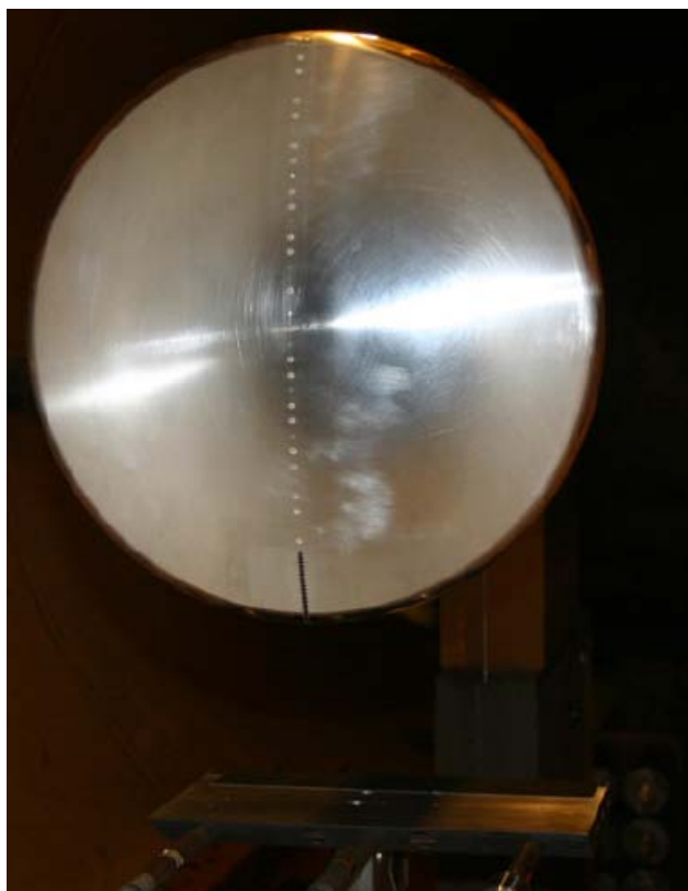
Рис. 20. Расположение датчиков теплового потока в передней части макета [56] модели спускаемого аппарата.
