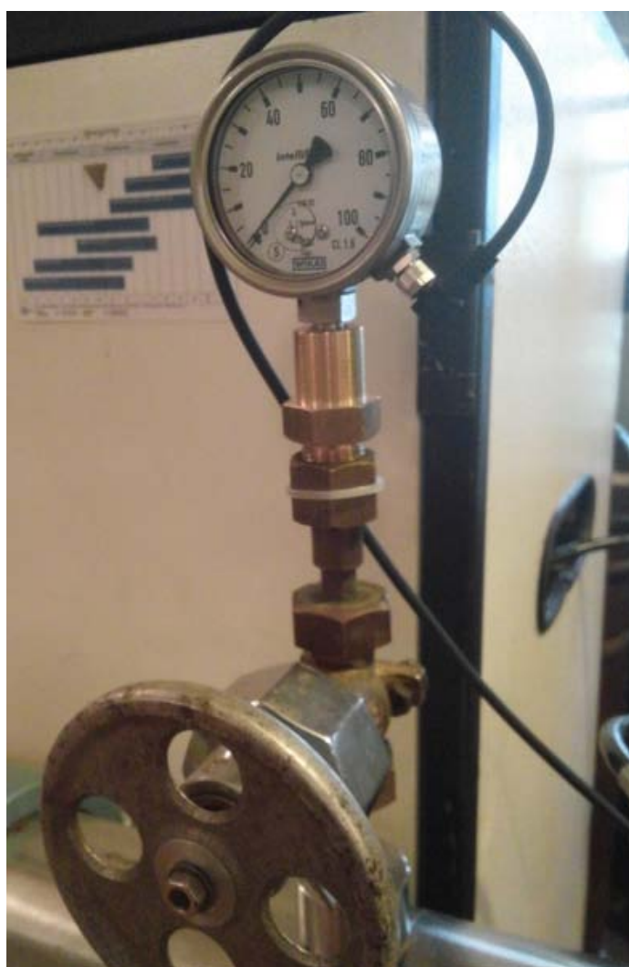
Рис. 61. Электрический манометр WIKA PGT 23.063 [157], закрепленный на КВД ГУАТ через перепускной кран.
