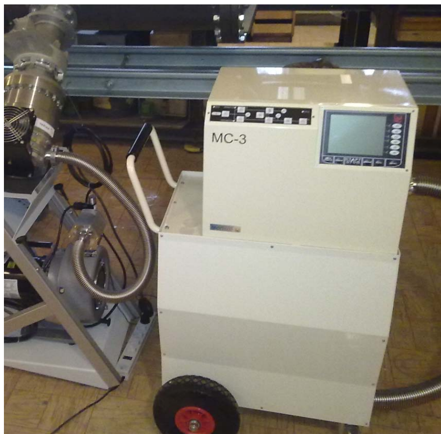
Рис. 59. Течеискатель MC-3 [147], подсоединенный к секции ресивера.
