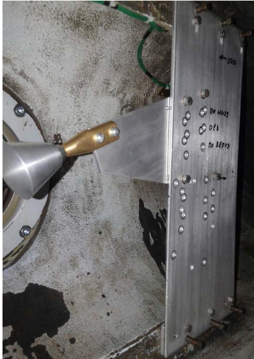
Рис. 112. Кронштейн с закрепленной моделью спускаемого аппарата в ресивере.
