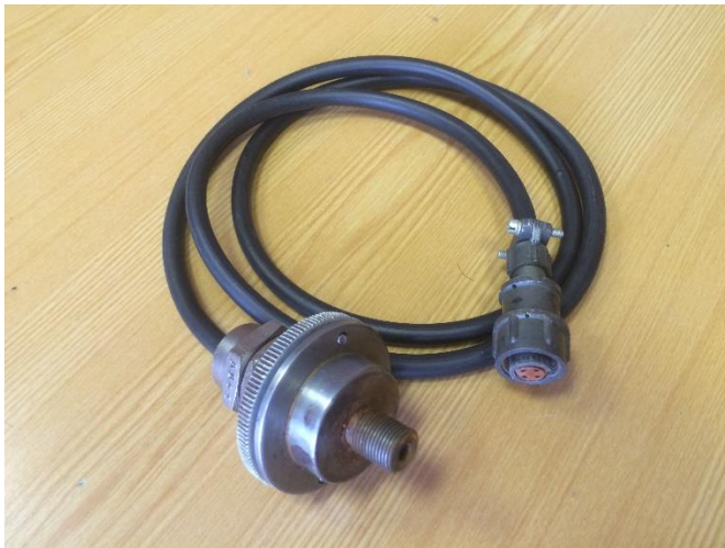
Рис. 5.2.(а) Внешний вид датчика давления ДД-6С
