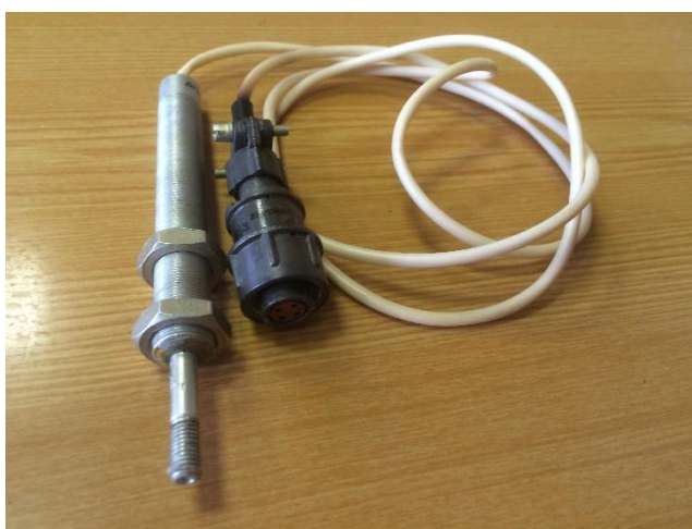
Рис. 5.3.(а) Внешний вид датчика перемещений
