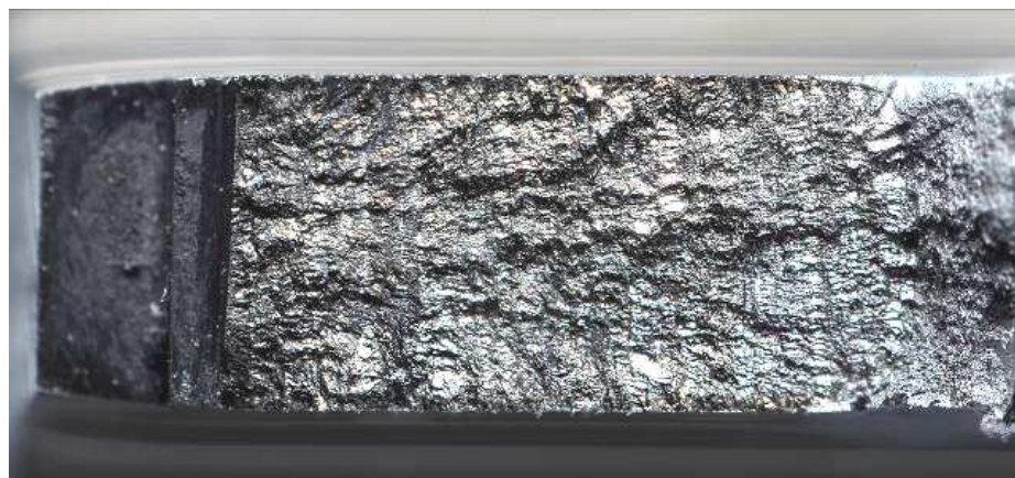
Рис. 1. Внешний вид излома усталостной трещины с квазипрямым фронтом
