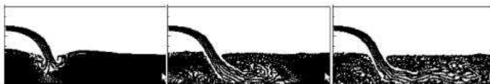
Рис. 5. Падение горизонтальной струи в бассейн. Тяжелая вязкая жидкость. (Дискретные маркеры).
