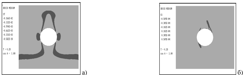
Рис.1. Распределение напряжений после прохождения волны через полость –а), распределение скольжений в окрестности полости – б)
